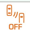
後側方接近車両注意喚起装置に異常があるときに点灯します。
