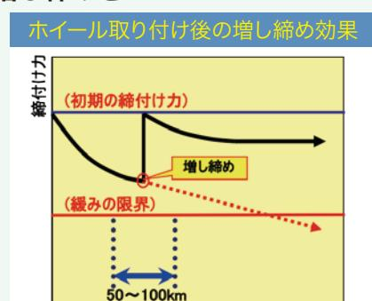
ハブのホイール取付面やホイールの合わせ面に、ゴミや泥、錆があると、初期なじみによる締付け力の低下が大きく、ホイール・ナットの緩みや脱落などに結びつきます。ホイール取付け時には、必ず清掃を行ってください。
