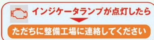
インジケータランプが表示されたまま使用すると、大幅な出力低下やエンジン自動停止が起こります。
