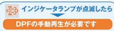
ランプ点滅時、一定時間内に手動再生を行えば良い場合や、速やかに手動再生を行わなければならぬ場合があるので、必ず使用的の車の取扱説明書をご確認ください。
